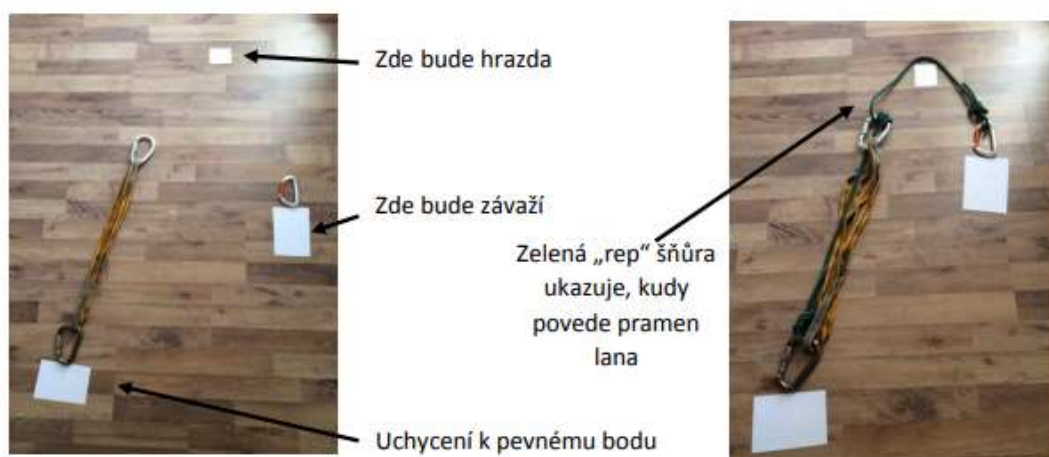
Obr. 4: Příprava na dynamický test lana
